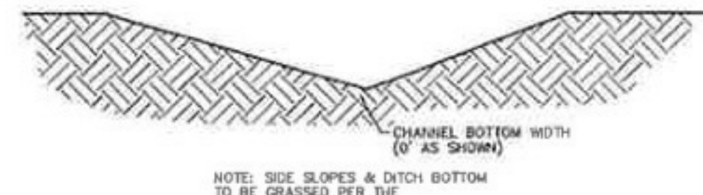
SWALE SECTION N.T.S.
